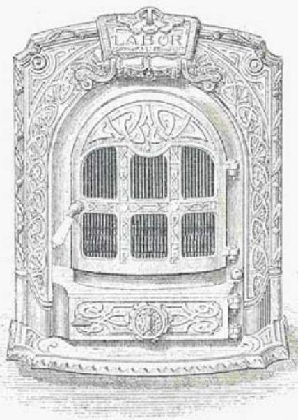
L'allumage s'effectue au moyen de charbon de bois bien embrasé déposé sur la grille de fond et recouvert de deux ou trois pelletées de combustible, la porte du cendrier étant ouverte.
